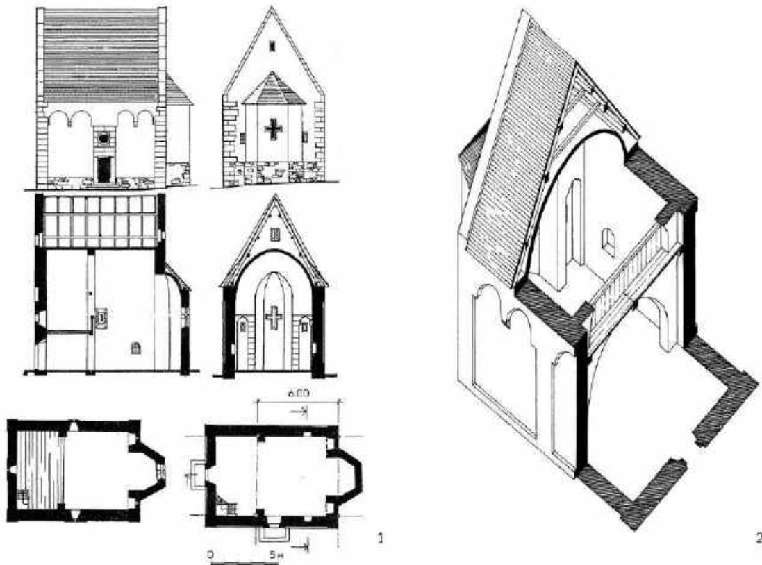
Рис. 6. Реконструкція первісного виду храму Івана Хрестителя: 1–2 – плани першого і другого ярусів, південний та східний фасади, повздовжній та поперечний перерізи. Автори: Л. Алінаускене, І. Могитич, В. Швець (за Могитич, 1997, рис. 3; НА ВА ІУ НАНУ. Матеріали Р. Багрія)
